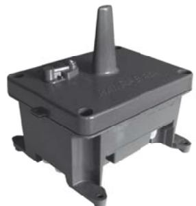
Radio domet između 2 TBOS radio releja može dosegnuti do 1200m na otvorenom. Radio domet između TBOS radio releja i TBOS-II radio adaptéra može dosegnuti 300m na otvorenom.
